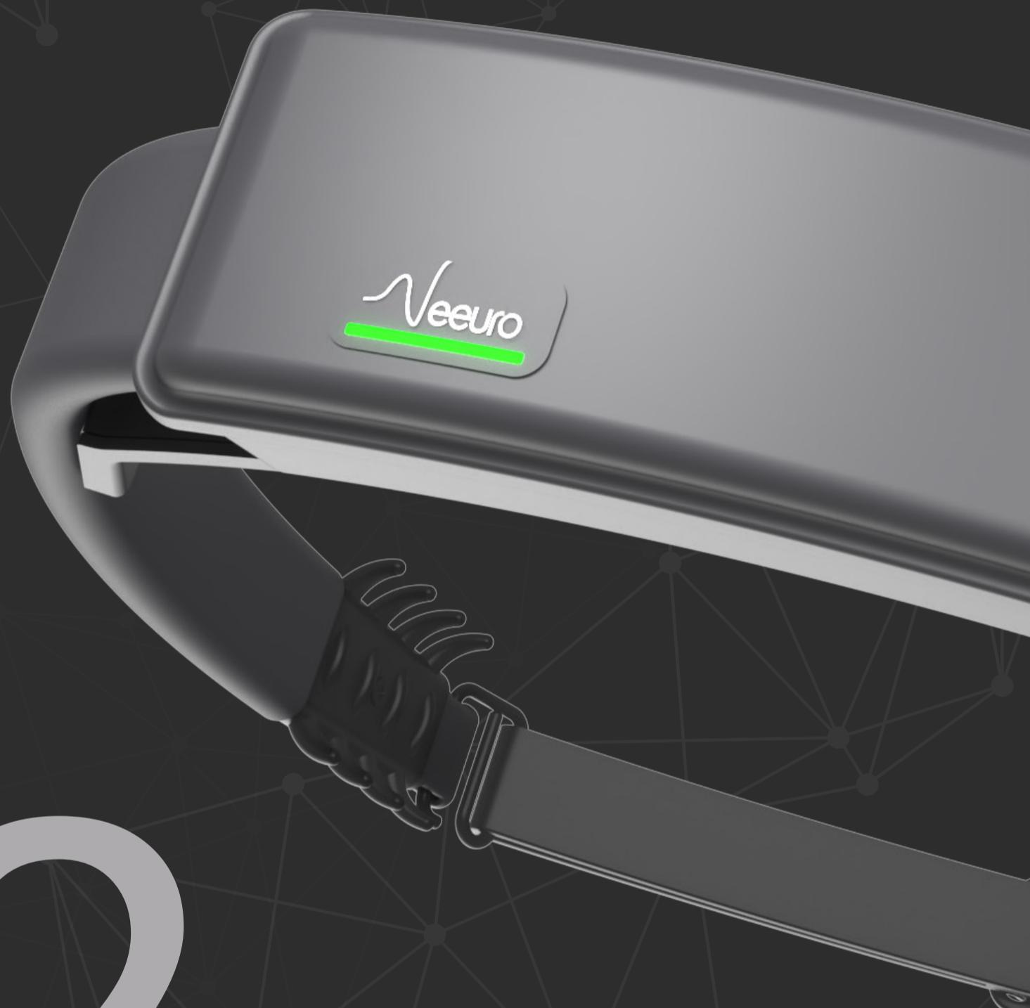
毅意脑头环2是一种用于捕获脑电波信号的无创设备。它由7个干电极组成，其中5个位于前额皮质，另外2个位于两侧。与毅意脑的机器学习算法一起，它可以解释各种精神状态，如注意力、放松、脑力工作量、疲劳、压力等；为实时测量提供富有洞察力的生物反馈，以驱动面对各种大脑挑战的干预。
